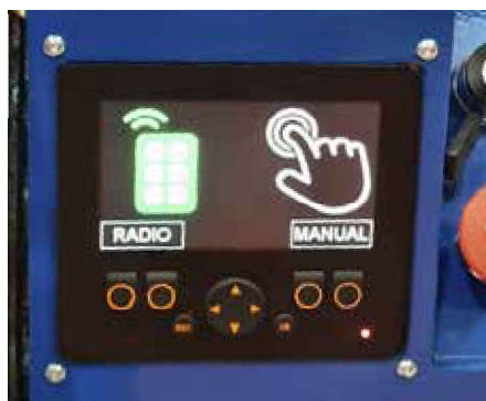
PLC display colour screen for managing machine Schermo a colori PLC per gestire la macchina
